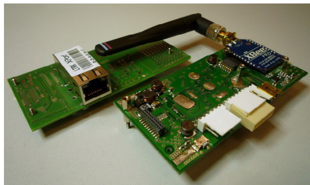
Slika 1: Vsestransko senzorsko vozlišče
