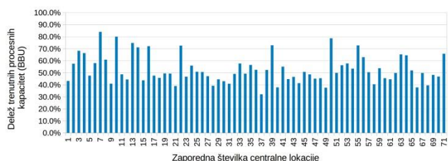
Slika 6: Delež trenutnih procesnih virov (BBU) potrebnih za nemoteno delovanje v primeru združitve celic v grozd.
